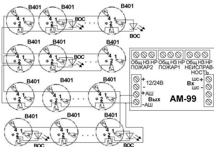
Рис. 5. Подключение модуля к базам В401.
