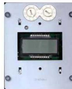
Рис. 2. Фальш-панель адресного модуля
