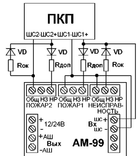
Рис. 8. Подключение реле ПОЖАР1, ПОЖАР2 к двум шлейфам ПКП с переполюсовкой напряжения
