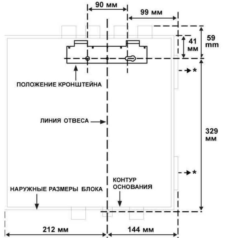
Рис. 6. Крепление монтажного кронштейна на стене
