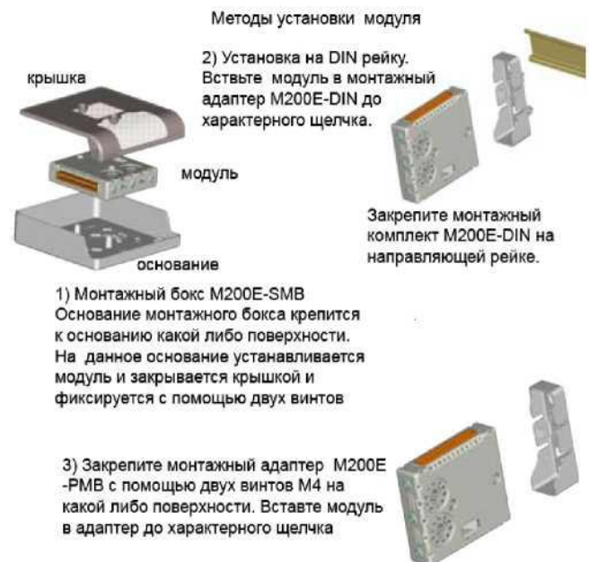
Рис. 1 Методы установки модуля
