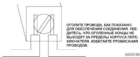
Рис. 4. Подключение проводников к терминалу
