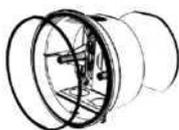
Для обеспечения степени защиты IP-55, установите прокладку на основание базы и уплотнительное кольцо после установки базы.
