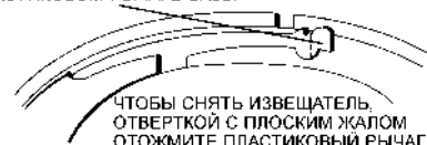
Рис. 2. Защита от несанкционированного извлечения извещателя
